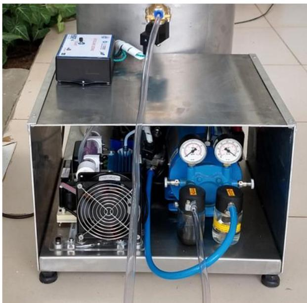
Figura 1: Autoclave para descontaminação de máscaras.
